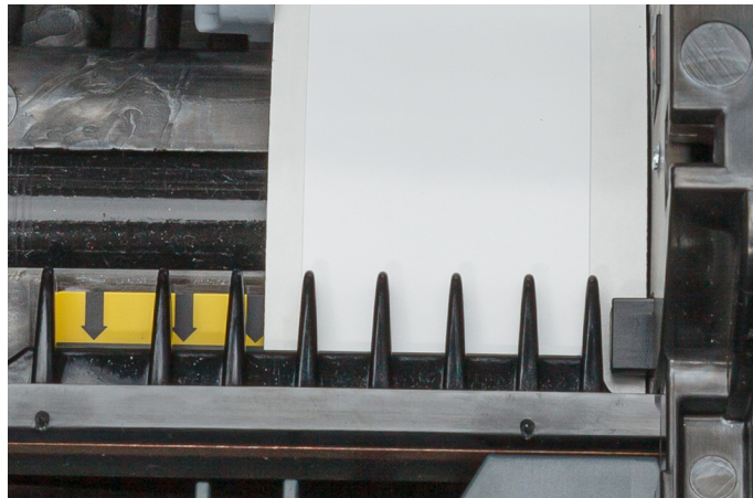
Abbildung 2-2. Position der Vorderkante des Etikettenverbrauchsmaterials.
