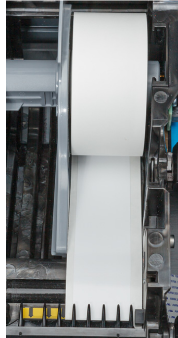
Abbildung 2-2. Position der Vorderkante des Etikettenverbrauchsmaterials.
