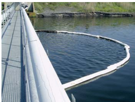
Mehrere Sperren bilden gemeinsam eine Barriere um die ausgetretenen Substanzen.
