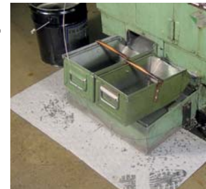
Eine gutes Allzweck-Sorptionsmittel, das um Maschinen gelegt werden kann, um den Sprühnebel zu absorbieren.
