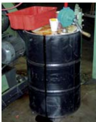
Keine Tropfen rinnen mehr beim Pumpen an der Seite des Fasses auf den Boden.
